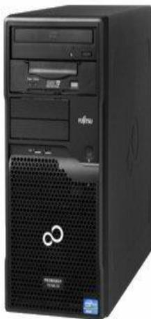
Son Format est identique à l'unité centrale d'un ordinateur. Sa particularité est qu'il peut être installé dans n'importe quelle pièce de l'entreprise, contrairement aux serveurs racks ou lames, qui nécessitent un emplacement spécifique pour fonctionner.
